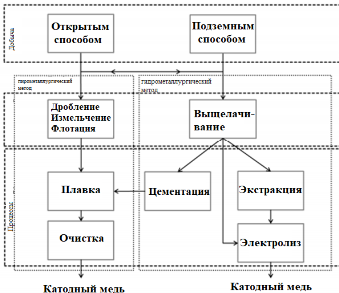
Рисунок 1.1 – Технологические методы производства меди
